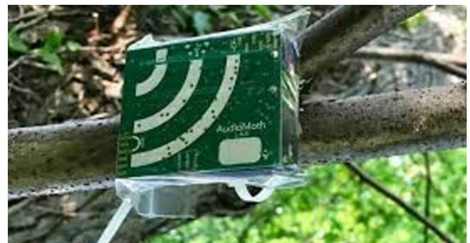
Sensor acústico de código abierto y económico AudioMoth (© Open Acoustic Devices)
