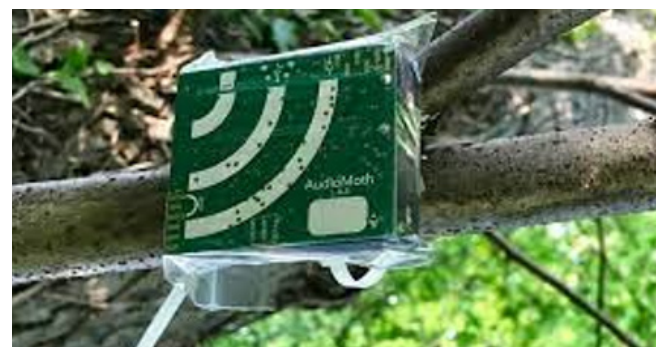
AudioMoth, sensor acústico de código aberto e baixo custo (© Open Acoustic Devices)
