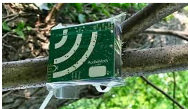
AudioMoth低成本开源声学传感器（© Open Acoustic Devices）
